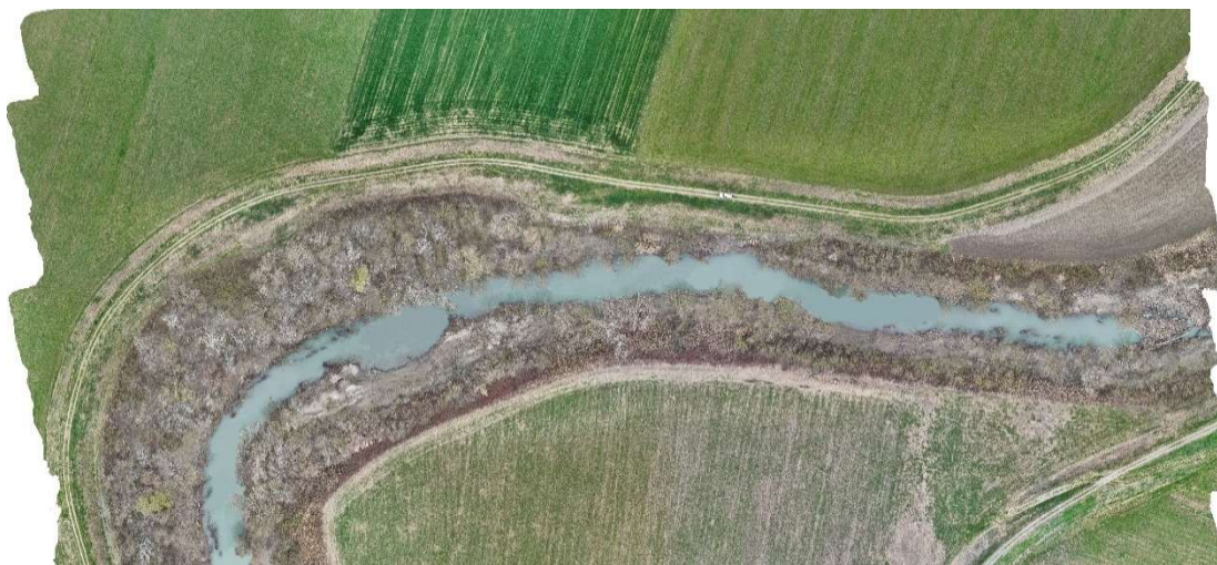
Figura 1 - Erosione in sponda sinistra stante 24
